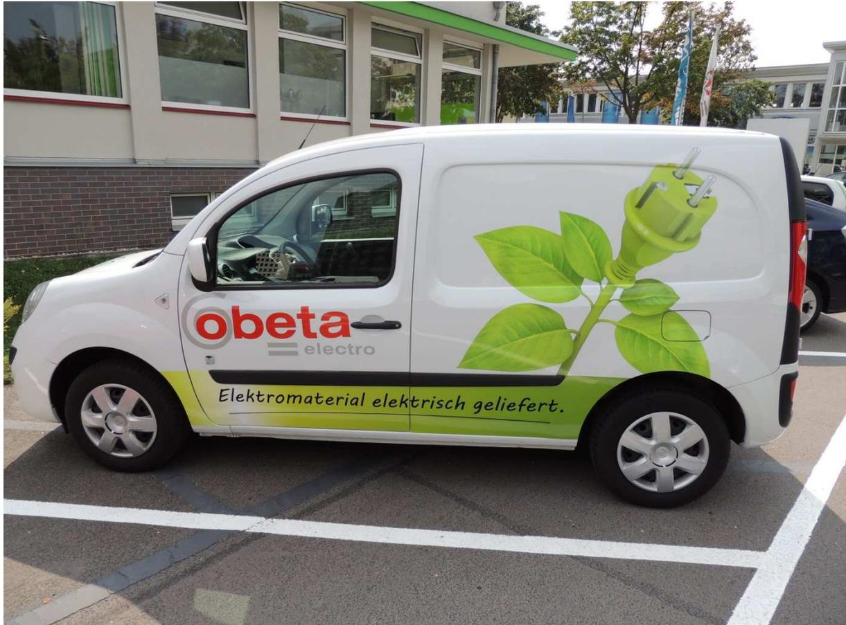
Renault Kango Z.E., Motor 44 kW, Batterie 22 kWh, Gesamtgewicht 2175 kg, Nutzlast 650 kg, Reichweite 90-120 km
